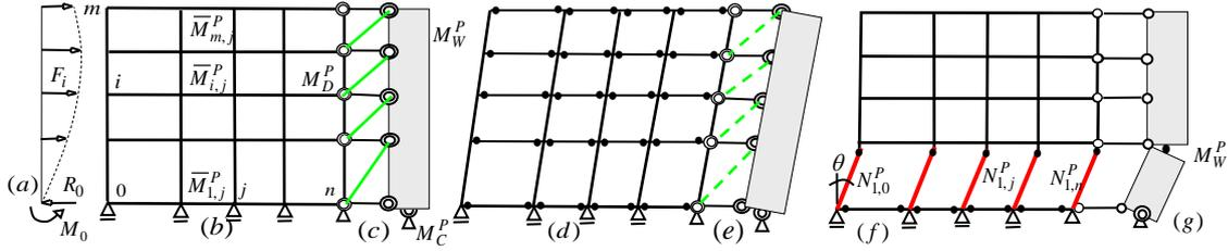
Figure 6. (b) RRMF, (c) RRW, (d) MF failure, (e) BRB failure, (f) Soft story failure, (g) Wall failure
